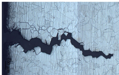
图2 主裂纹尖端形貌 Fig.2 Morphology of main crack tip
