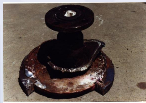
(a) 将送检试样在裂纹两端钻孔后即掉下一块，漏出裂纹的断口。钻孔处并非裂纹的尖端
